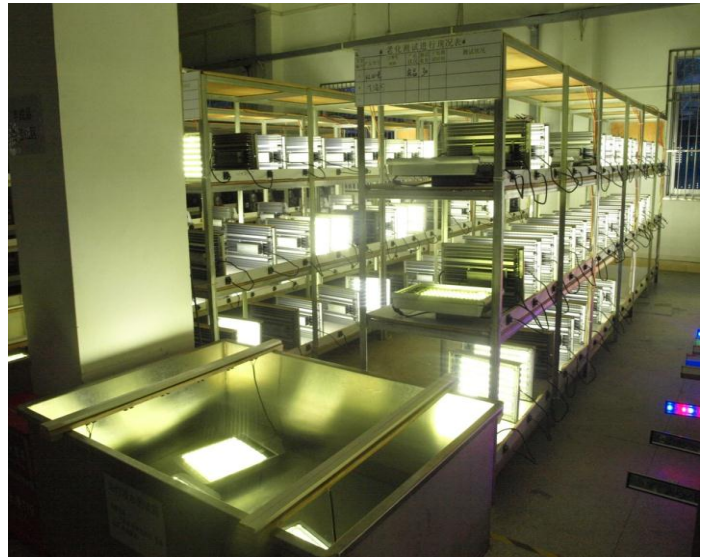
تصویر 7: آزمایش کارکرد چراغ led- 72 ساعت
