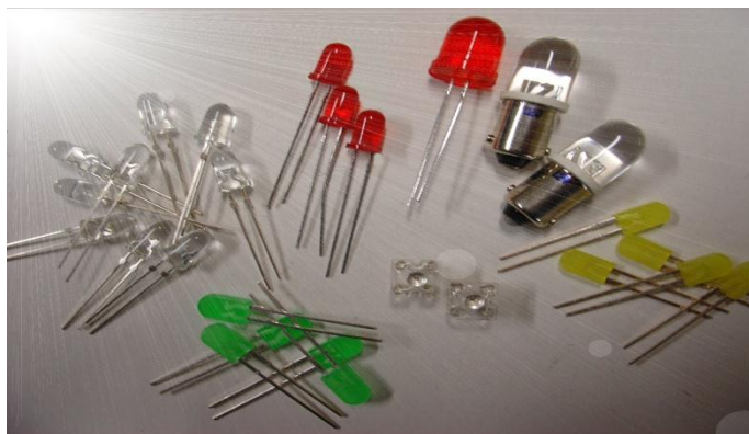
تصویر 2: انواع led نوع low power
